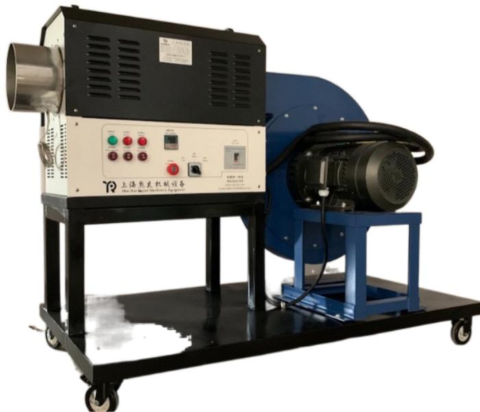
循环热风机的注意事项：安装注意事项，能避雨雪的室内干燥处，避潮湿；通风良好，忌在密封箱中使用；远离易燃、易爆等危险物品及气体；安装时出风口须上倾15°，下倾10°范围内，机体左右倾度在15°范围内使用；进风口不可阻塞，出风口用包有隔热材料的配管连接，注意配管不应过长过细过弯及弯曲也不应过多。使用环境要求：空气中无粘性和纤维物质，含尘量和其它固体杂质的含量不大于100mg/m<sup>3</sup>。工作时环境温度在-10℃~40℃之间，湿度在85%（不结露）以内。沈阳气体循环热风机循环热风机包括燃烧系统和风机两大部分，燃烧系统产生巨大的热量然后由风机往外吹出热量。
